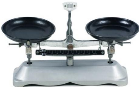
La masse d'un objet est associée à la quantité de matière qu'il contient. Idéalement, on mesure une masse à l'aide d'une balance par comparaison avec une masse connue, une masse étalon. On l'exprime en kilogrammes ou en grammes.
