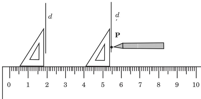
Fig. 1.3 Tracé d'une droite  $d'$  parallèle à la droite  $d$
