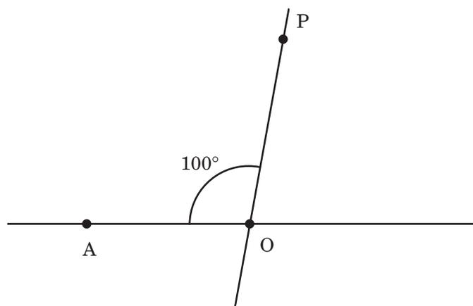
5° placer la pointe sèche du compas au point O et régler l'ouverture du compas au moyen de la vis de serrage de façon que la pointe traçeuse se trouve sur le point A;
